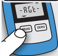
Los refractómetros OPTi tienen un exclusivo modo de "prueba AG" que facilita la verificación utilizando fluidos AG de larga duración con trazabilidad NIST sin la necesidad de considerar la escala o el tipo de ATC.
